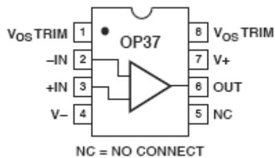
Fig. 18 Pin Diagram for OP37 OPAMP
