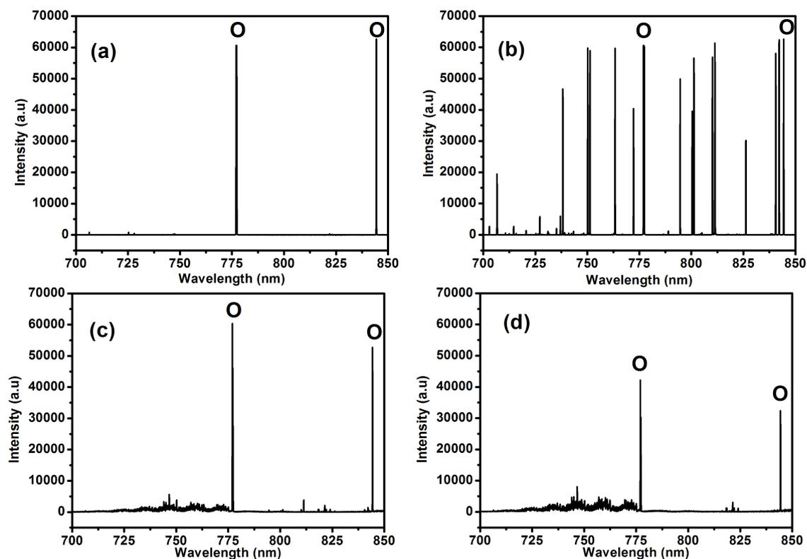
Fig. 5.4: Optical emission spectra for various plasma ambient (a)  $O_2$  (b)  $Ar + O_2$  (c)  $N_2 + O_2$  (d)  $N_2O$ .
